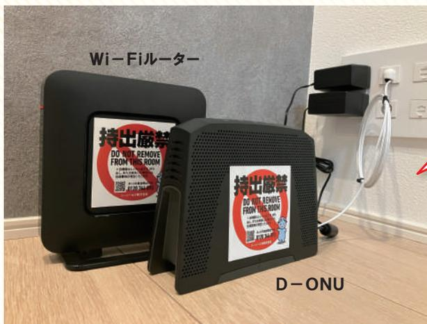
1部屋に2台の機器、D-ONUとWi-Fiルーターが設置されています。設置位置は物件によって異なります。SSIDとPASSはルーターに貼られたシールに記載されています。
